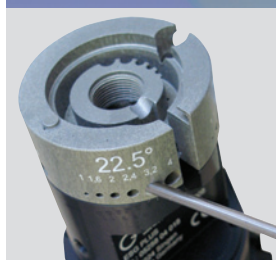
Affilatura: 4 angoli e 6 diametri diversi
