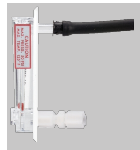
Connessioni modello MMF. Il connettore nella parte superiore, installato nel pannello, è dotato di fermo e tubo flessibile. Il connettore nella parte inferiore mostra una connessione alternativa con tubo in metallo o plastica rigida, utilizzando un raccordo a doppia compressione in nylon (codice Dwyer A-328).
