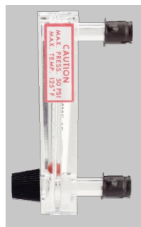
Il modello MMF si monta facilmente dalla parte anteriore del pannello. Praticare due fori da 9/32" o 5/16" di diametro nel pannello con un interasse di 2-1/16". Inserire i perni di montaggio. Da dietro, far scorrere i due fermi a molla (in dotazione) e spingere sul tubo di gomma o plastica.
